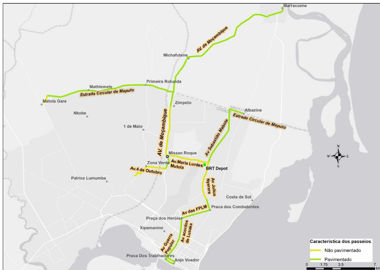
Figura 6: Características dos passeios nas vias abrangidas pelo sistema de BRT, em termos de presença ou não de pavimento.
